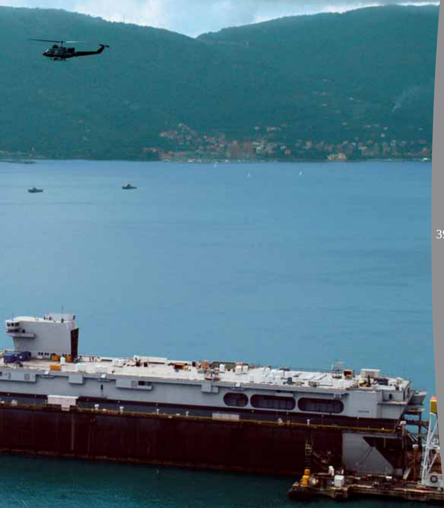
Movimentazione del troncone prodiero della portaerei "Cavour" Bow section transfer of the aircraft carrier "Cavour"
